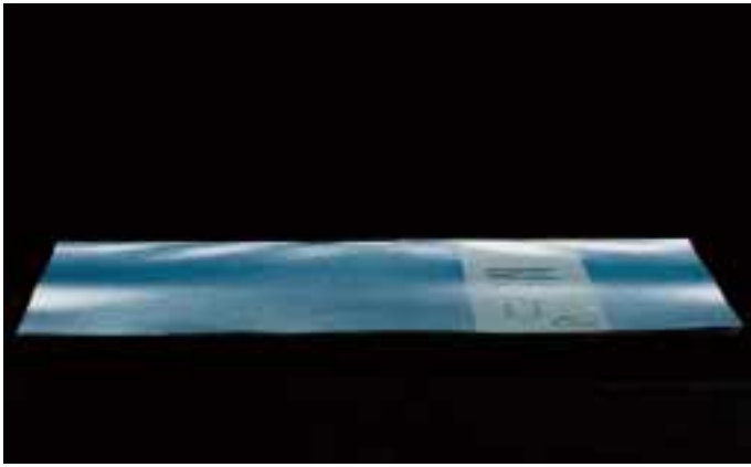
Ilus. I: El papel a contrafibra de encuadernación ocasiona lomos ondulados en los folletos.
