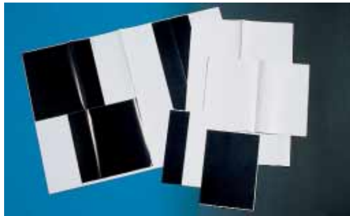
Ilus. C: Pliegos impresos y en blanco, plegados de 16 páginas. Las páginas impresas simulan páginas a "sangre".
