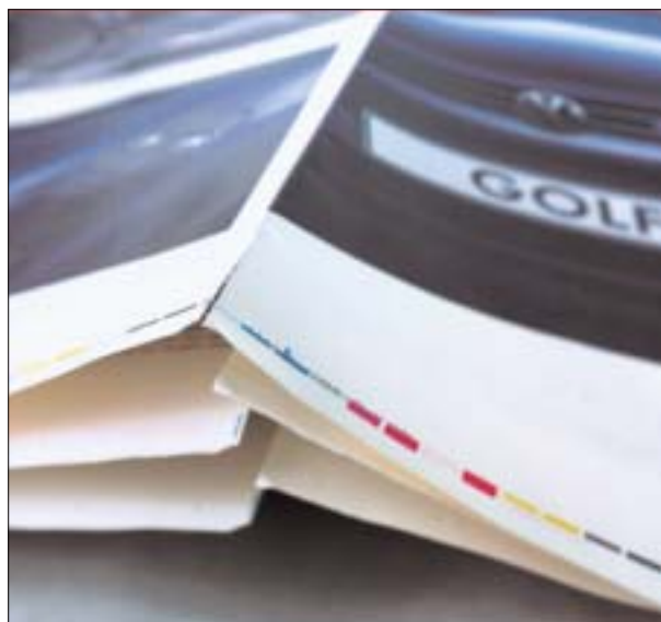
Roturas en pliegue
