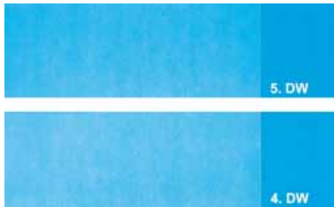
Ilus. E Impresión en una máquina Heidelberg de 5 colores: 1ª serie: aditivo a la solución de origen 1, elevado flujo de agua , resultado: el papel de ensayos presenta mottling en mecanismos impresores 4 y 5.
