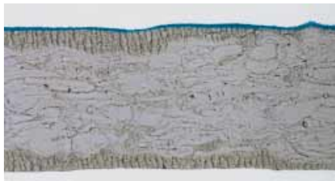
Ilus. G Foto con película de capa delgada de emulsión con color/estucado/fibra/estucado: Con un flujo escaso de agua se obtiene una película de tonos más llenos.
