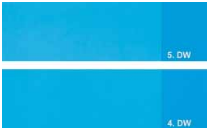
Ilus. D Impresión en una máquina Heidelberg de 5 colores: 1ª serie: aditivo a la solución de origen 1, escaso flujo de agua , resultado: el papel de ensayos no presenta mottling en mecanismos impresores 4 ni 5.
