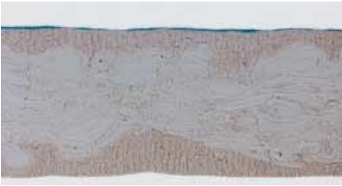
Ilus. H Foto con película de capa delgada de emulsión con color/estucado/fibra/estucado: Con un flujo elevado de agua se obtiene una película de colores desgarrados en el papel de ensayo.
