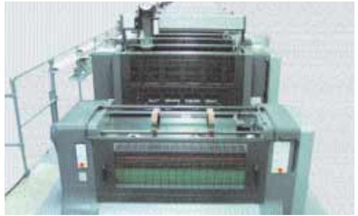
Ilus. A13 Mecanismo de lacado en línea con secado prolongado.
