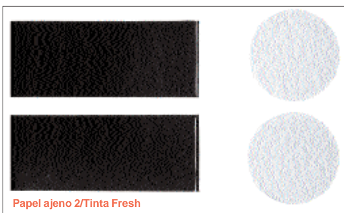
Ilus. B11 (arriba) y Ilus. B12 (abajo) Las mismas tintas impresas en papel semimate y sometidas a abrasión presen-
